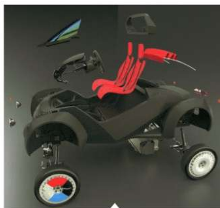
Le véhicule est constitué d'une quarantaine d'éléments imprimés en 3D.
