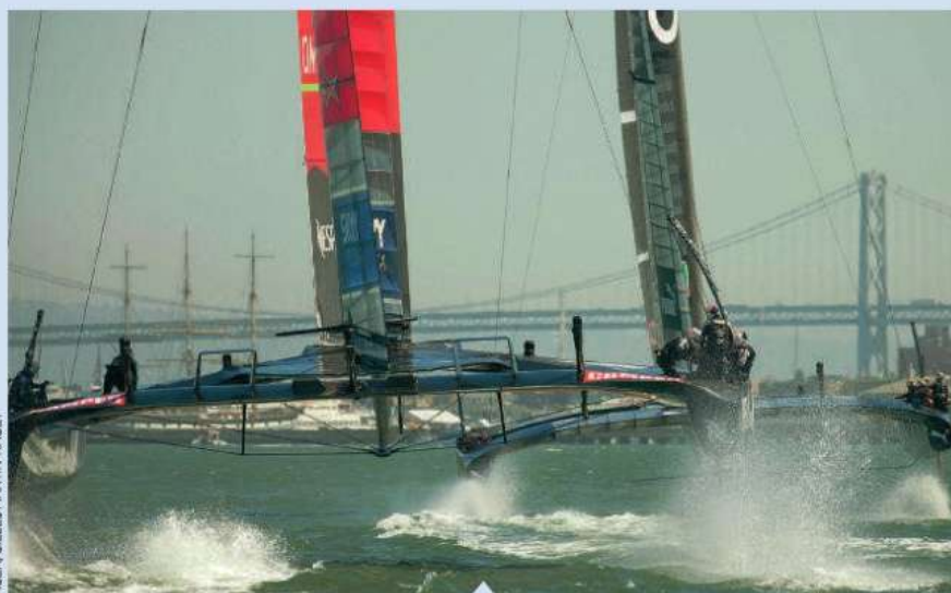
Lors de l'America's Cup de 2013, les bateaux ont régaté au-dessus de l'eau, portés par leurs foils, ces grands ailerons placés sous les coques.
